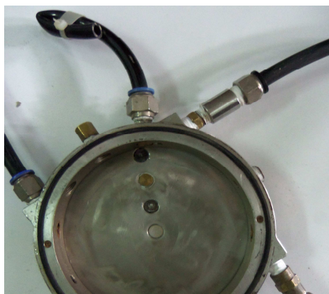
Рис. 6. Фрагмент боковой стенки вихревой камеры
