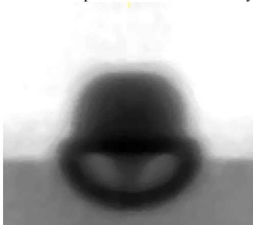
Рис. 8. Рентгенограмма исследования струйных течений в газодинамическом макете. Оптическая толщина – 460 мм по Fe
