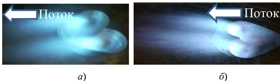
Рис. 9. Горение при подаче газа в точке 3: а – в прямом положении; б – в обратном положении
