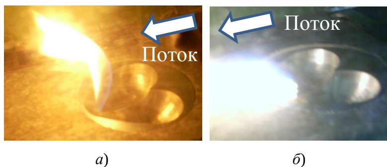
Рис. 7. Горение при подаче газа в точке 1: а – без основного потока; б – с основным потоком
