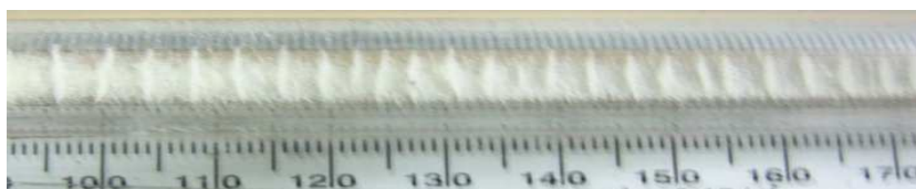
Рис. 4. Фотография периодических структур внутри прозрачной полости ТГШ
